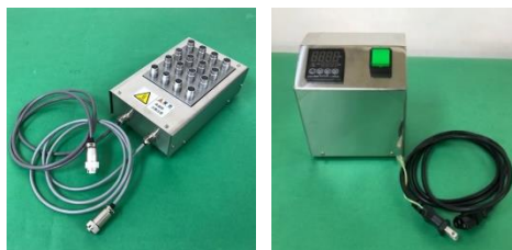
AHST-16HB 16バイアル用ヒートブロック AHST-16TC 16バイアル用温度コントローラー
