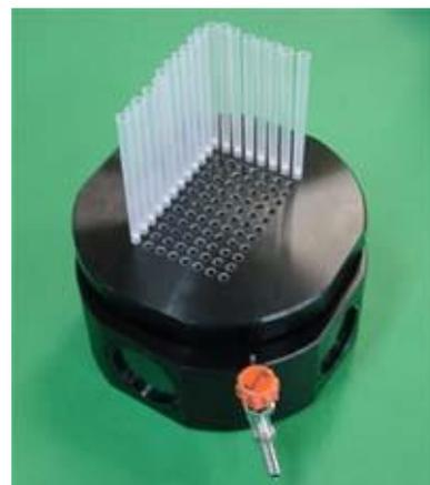
本体部分はアルマイト処理のため塩酸の接触は不適、但し10 mmol塩酸は数時間間接触で問題無し、他の有機酸・アルカリ・有機溶媒は使用可能（使用後速やかに洗浄するのが望ましい）
